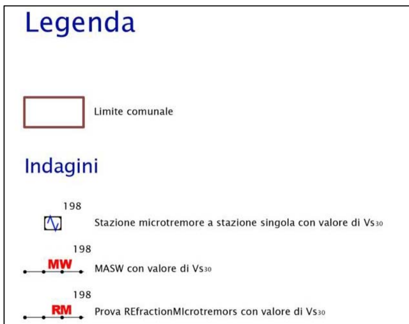
Figura 52 – Esempio di legenda della Carta delle velocità delle onde di taglio S ( V_s ).
