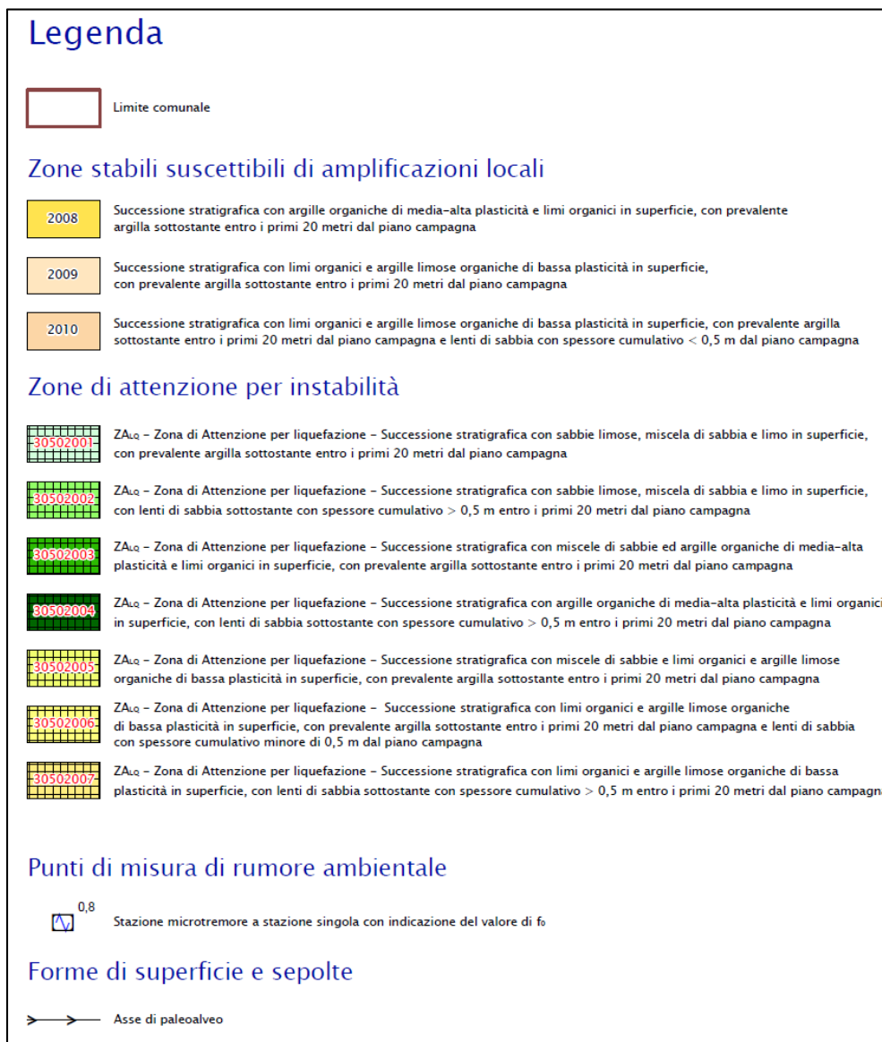
Figura 41 – Esempio di legenda della Carta delle microzone omogenee in prospettiva sismica (livello 1).
